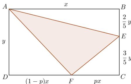
De la primera condición resulta  $BE = \frac{2}{5}y$ , siendo  $y = BC$ . Si  $CF = px$ , siendo  $AB = x$ , de la segunda condición resulta
