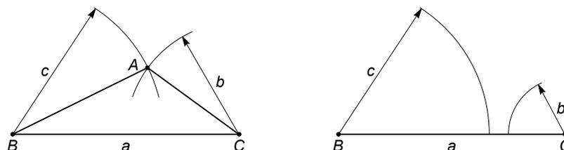
FIGURA 3. Construcción de un triángulo dados sus lados  $a$ ,  $b$  y  $c$ . Si alguna de las desigualdades triangulares  $a < b + c$ ,  $b < a + c$  o  $c < a + b$  no se cumple, entonces es imposible construir el triángulo.
