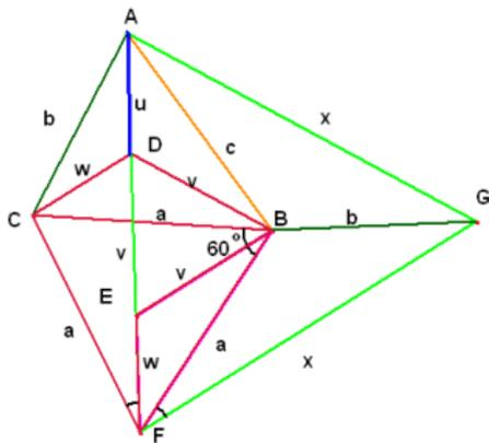
$DBE$  y  $BCF$  son triángulos equiláteros, luego  $DE = v$  y  $CF = a$ . Los puntos  $A$ ,  $D$ ,  $E$  y  $F$  están alineados, pues  $120^\circ + 60^\circ = 180^\circ$ , así que  $AF = u + v + w$ .
