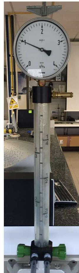
Usando este dispositivo, en la siguiente tabla se recoge una serie de valores de presión  $p$  medidos experimentalmente para varios valores del volumen  $V$ :
