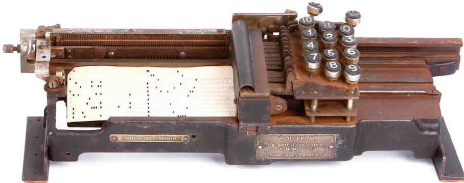
**IV-2-1** / Keypunch, primera perforadora automática de tarjetas Hollerith
