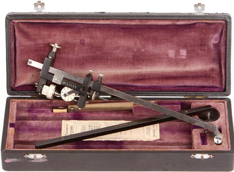
**V-4-1** / Planímetro, para el cálculo automático de superficies
