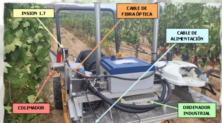
Figura 1. Equipo empleado para las mediciones espectrales en continuo con sus diferentes partes instaladas sobre la plataforma móvil terrestre.
