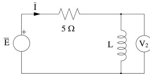
Medida de  $V_2 = 20 \text{ V}$
