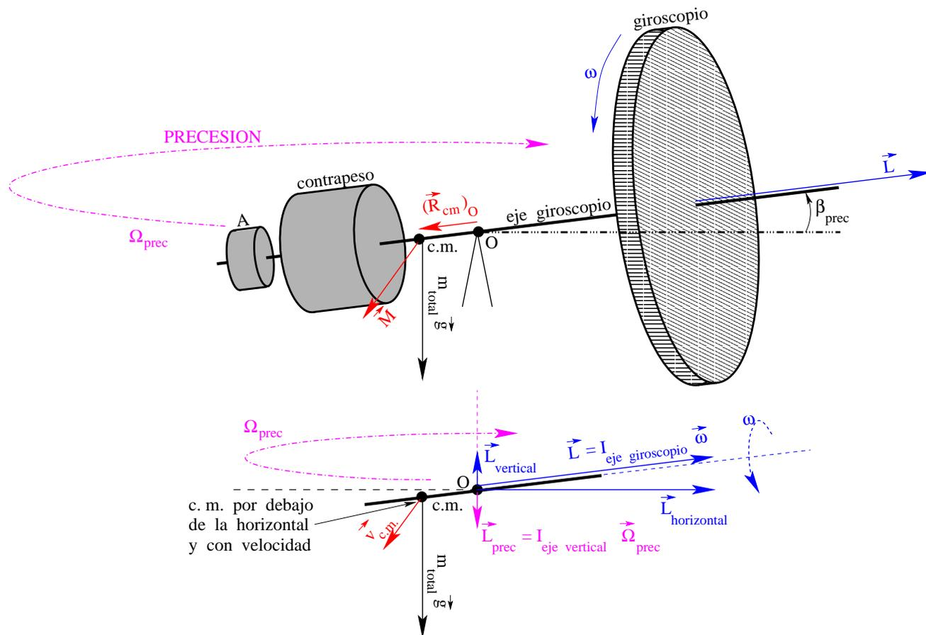
Inicialmente, cuando sujetamos el eje del giroscopio en posición horizontal, el momento angular está también en posición horizontal. Sin embargo, cuando el giroscopio
