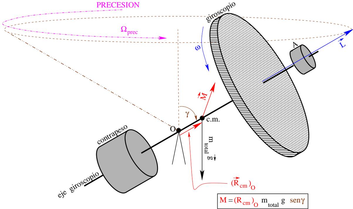
al punto de apoyo sigue siendo perpendicular al momento angular del giroscopio; y sigue estando contenido en un plano paralelo al suelo. El cambio del momento angular, que sólo es un cambio en dirección y por tanto es igual al cambio de dirección del eje del giroscopio, es trazar un cono cuya generatriz es el propio eje del giroscopio. La inclinación del eje del giroscopio no es modificada por el peso.
