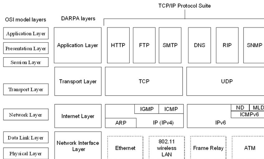
1. Ethernet es un protocolo de la capa física de la pila TCP/IP. Su funcionamiento está basado en el uso de tarjetas de red que contienen una dirección MAC (Media Access Control) de 6 bytes que es única para cada dispositivo.
