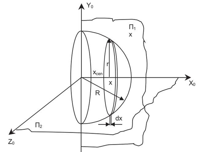
$$H = \begin{bmatrix} H_x \\ H_y \\ H_z \end{bmatrix} = \begin{bmatrix} y^2 + z^2 & -xy & -xz \\ -xy & z^2 + x^2 & -yz \\ -xz & -yz & x^2 + y^2 \end{bmatrix} \cdot \begin{bmatrix} \omega_x \\ \omega_y \\ \omega_z \end{bmatrix} \cdot dm$$
