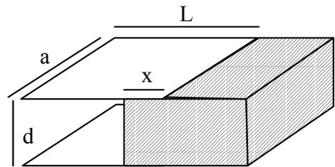
19.- A las láminas de un condensador plano-parallelo con un dieléctrico en su interior se les ha comunicado cierta diferencia de potencial. La energía almacenada en el condensador en esta situación es de  $2 \cdot 10^{-5}$  J. Después de desconectar el condensador de la batería, se extrae el dieléctrico del condensador. El trabajo realizado en este caso para vencer el campo eléctrico es de  $7 \cdot 10^{-5}$  J. Calcula la constante dieléctrica  $\kappa$  del material aislante.
