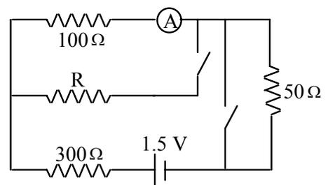
19.- Calcula  $I_1$ ,  $I_2$  e  $I_3$ , y la diferencia de potencial entre el punto b y el punto e del circuito de la figura.
